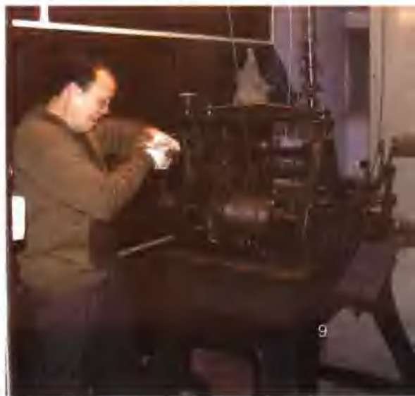
大钟的心脏由两部分机械组成，一部分是走时钟，用钟楼外面的四个钟面来显示时间；另一部分是鸣时钟，用大锤敲击楼里的大钟来报时。走钟和打钟在时间上虽然同步，但各自的发条不同。走钟的发条每五天上一次，打钟的发条每三天上一次。给这么大的钟上发条，的确是个力气活。
