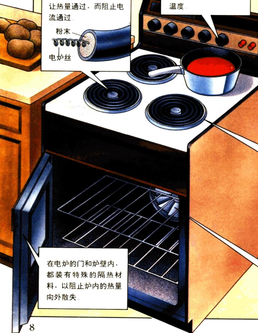
在电炉的门和炉壁内，都装有特殊的隔热材料，以阻止炉内的热量向外散失。
