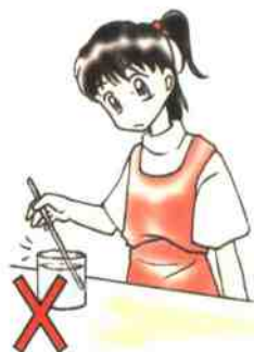
(c) 温度计下端不能与杯底、杯壁接触
