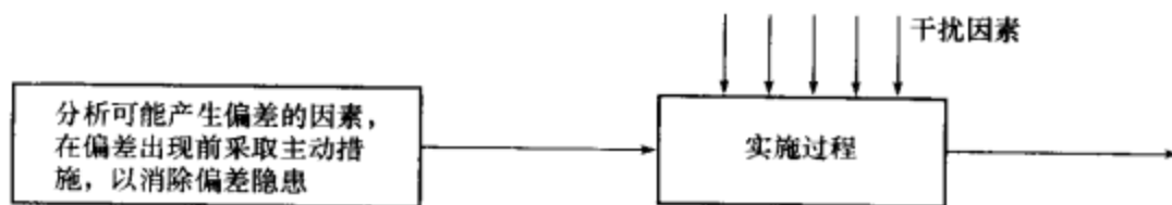
图 1-2 项目目标控制原理（主动控制）
