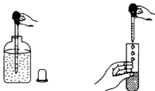
①取出滴管,挤去空气,插入待取试剂中,使试剂吸入滴管 ②挤压橡皮滴头,使液体试剂滴入试管,滴管不可接触试管壁
