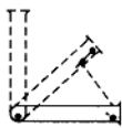
②使试管慢慢竖起,让试剂沿试管壁慢慢滑到试管底部
