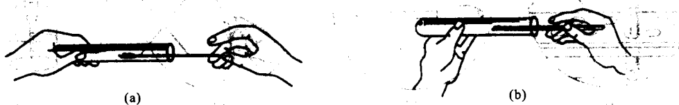
图1.1 粉末状固体取法
