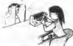
验钞机发出的紫外线使钞票上的荧光物质发光
