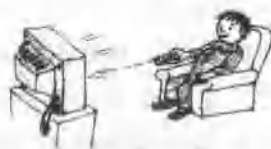
电视机的遥控器通过红外线进行控制
