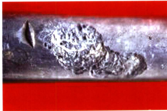
图 19.3.5 裸铅护套在草甸褐土中腐蚀斑坑聚集在小区域内(见正文 472 页) 土壤 pH 值 8.1; 埋设 28 年; 铅护套厚度 1.5mm; 最大孔蚀深度 1.5mm(已穿孔); 腐蚀速率 0.08\text{g}/(\text{dm}^2 \cdot \text{a}) ; 腐蚀产物 \text{PbCO}_3 \cdot \text{PbO} (较多)
