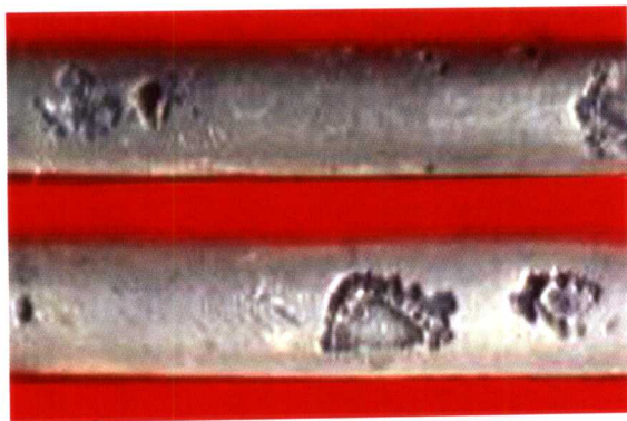
图 19.3.6 裸铅包电缆在紫色土中呈局部斑点腐蚀(见正文 472 页) 土壤 pH 值 8.6; 埋设 29 年; 铅护套厚度 1.5mm; 最大孔蚀深度 1.5mm(已穿孔); 腐蚀速率 0.28\text{g}/(\text{dm}^2 \cdot \text{a}) ; 腐蚀产物 \text{PbCO}_3 (占 82.8%)
