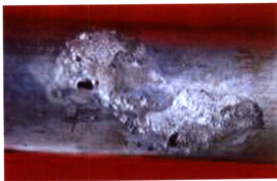
图 19.3.21 裸铝护套在苏打盐土中多处穿孔(见正文 482 页)
