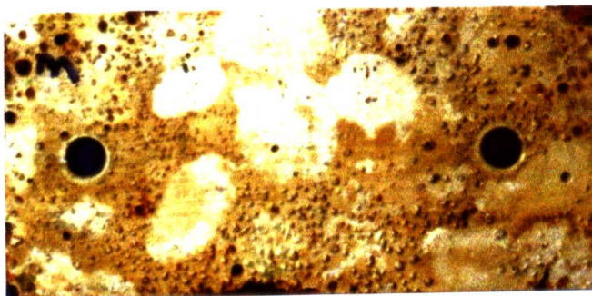
图 15.2.2 环氧富锌/31011 环氧聚氨酯涂层在榆林站全浸区暴露 8 年腐蚀外观(见正文 362 页)
