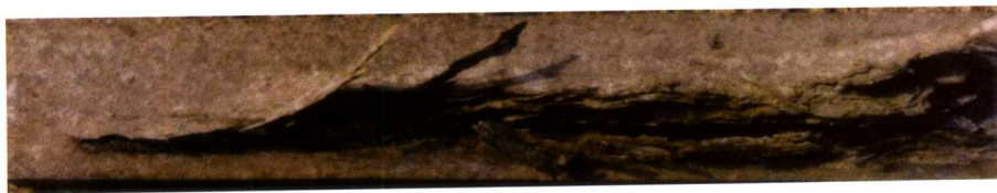
图 6.2.6 硬铝合金(LY12) 大气暴露 8 年发生的剥层腐蚀(见正文 111 页)
