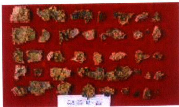
图 19.3.22 涂装钢带在赤红壤中埋藏 8 年后, 只剩下碎铁渣(见正文 486 页)
