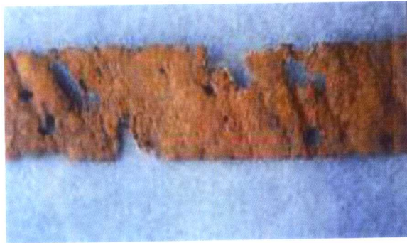
图 19.4.3 钢带穿孔、残缺、断裂(见正文 488 页)
