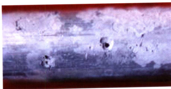
图 19.3.19 裸铝护套在灰棕漠土中呈孔蚀, 蚀孔小而深(见正文 482 页) 土壤 pH 值 8.7; 埋设 1 年; 铝护套厚度 1.5mm; 最大孔蚀深度 1.5mm(多处穿孔); 腐蚀速率 0.33\text{g}/(\text{dm}^2 \cdot \text{a}) ; 腐蚀产物为透明的结晶颗粒
