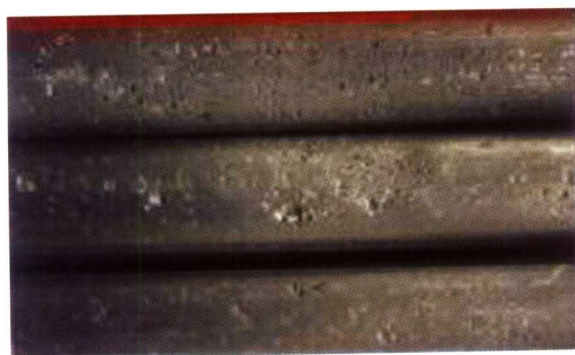
图 19. 3. 1 裸铅护套在红壤中呈斑点腐蚀，蚀孔小而深(见正文 472 页) 土壤 pH 值 4. 3；埋设 3 年；铅护套厚度 1. 5mm；最大孔蚀深度 0. 98mm； 腐蚀速率 0. 53\text{g}/(\text{dm}^2 \cdot \text{a}) ；腐蚀产物 \text{PbCO}_3 (占 74. 9%)
