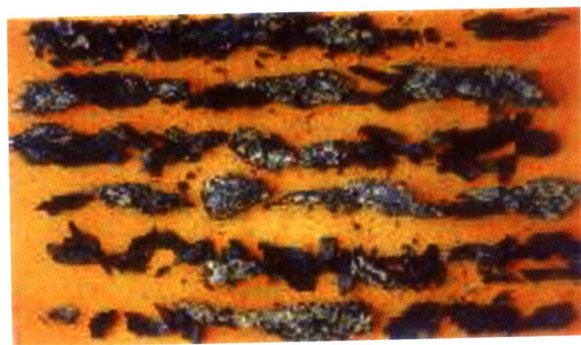
图 19.4.1 油麻绳腐烂、脆断、丧失拉力(见正文 487 页)
