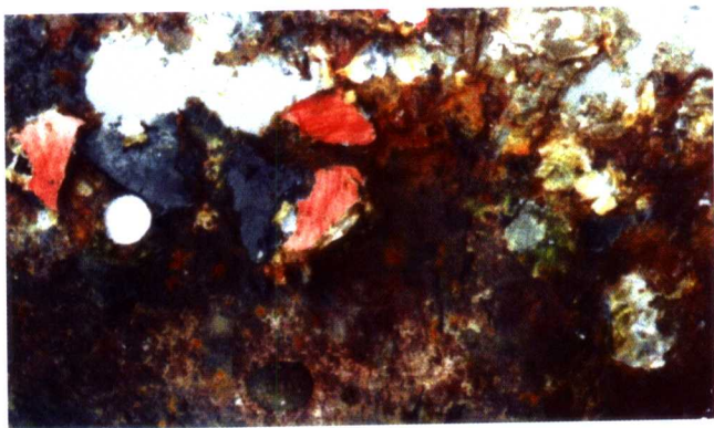
图 15.2.5 氯磺化聚乙烯涂层在青岛站潮差区暴露 7 年海生物引起剥落(见正文 363 页)
