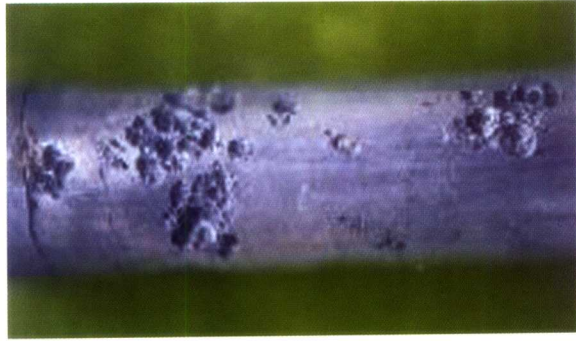
图 19.4.2 麻被下的铅护套已蚀穿(见正文 488 页)
