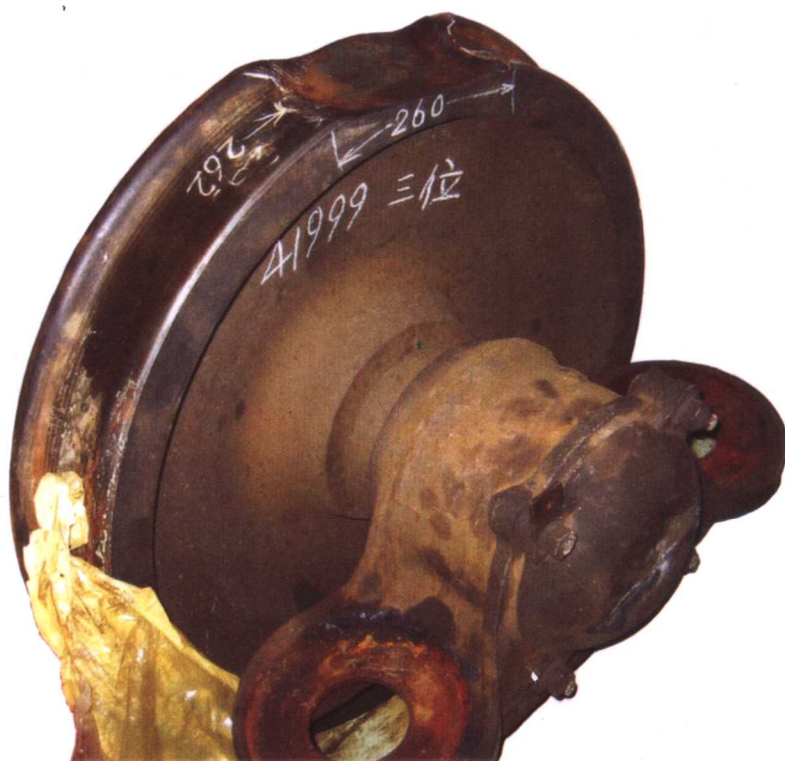
图 1-5 轮辋裂损形貌之一
