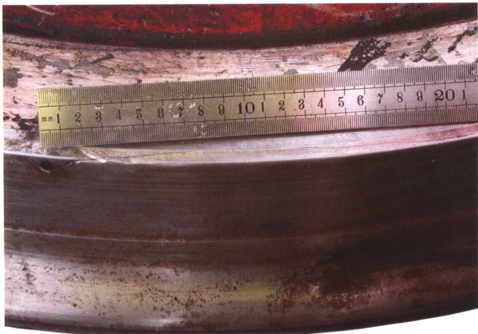
图 1-1 发展到轮辋外侧面轮辋疲劳裂纹
