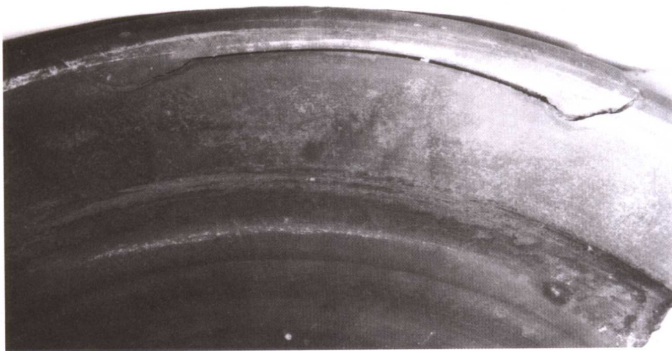
图 1-2 发展到轮辋内侧面轮辋疲劳裂纹形貌之一
