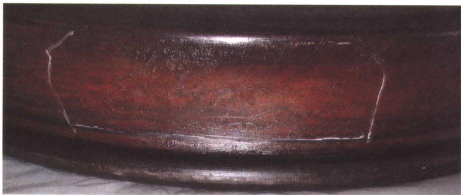
图 1-13 超声波探伤检查轮辋内部疲劳裂纹区域
