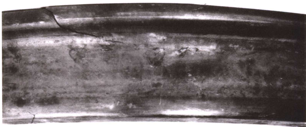
图 1-4 发展到轮缘部位轮辋疲劳裂纹形貌
