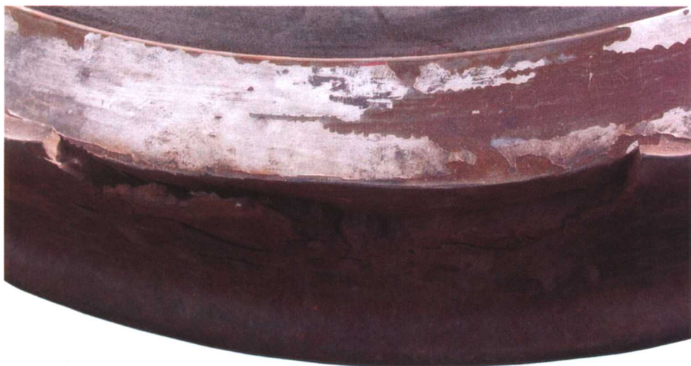
图 1-9 轮辋内部疲劳裂纹及裂损形貌之四
