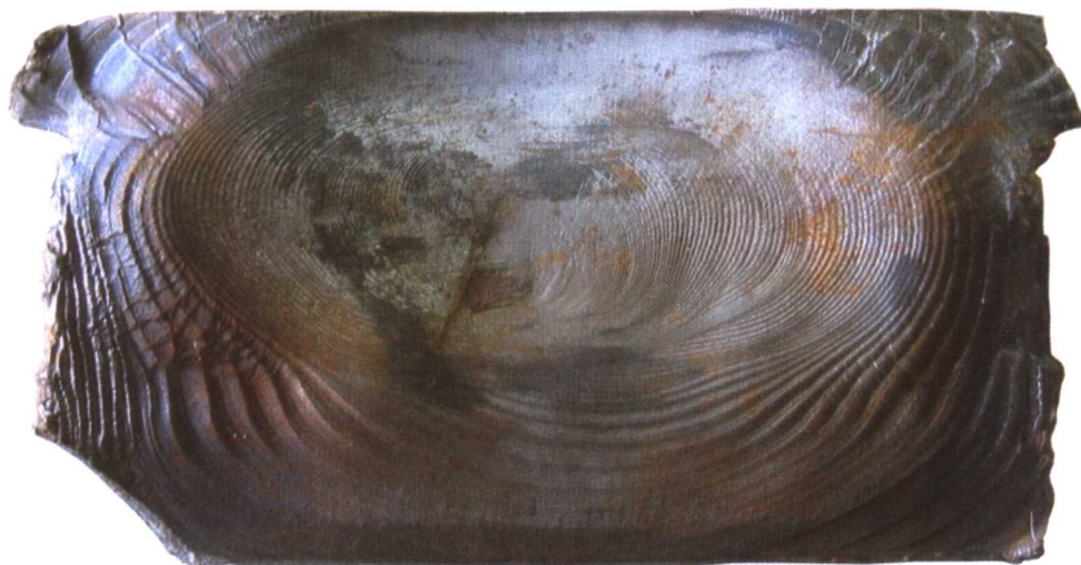
图 1-7 (图 1-5、图 1-6) 所示轮辋裂损之偶合面
