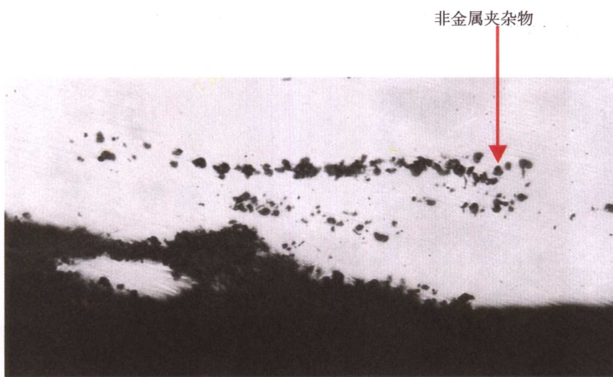
图 1-12 金相显微镜下裂纹源处大颗粒链状非金属夹杂物
