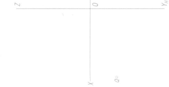
(2) 画正平线 CD, 距 V 面 20mm, 与 H 面成  $60^\circ$  夹角, 实长 25mm, 并已知投影  $c'$ 。
