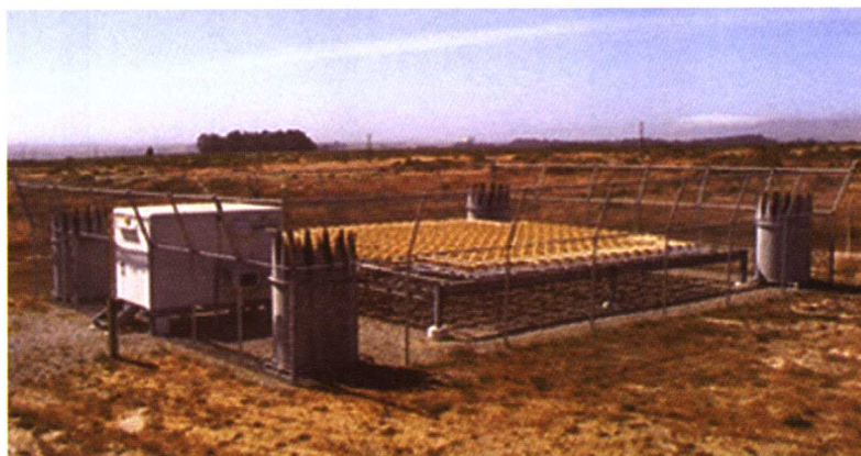
图1.9 配有RASS的相控阵风廓线雷达系统
