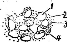
圖2 手工拌和后的造型砂(已加水): 1—砂粒; 2—粉狀粘結剂等; 3—粘結劑薄膜; 4—塊狀粘結劑。
