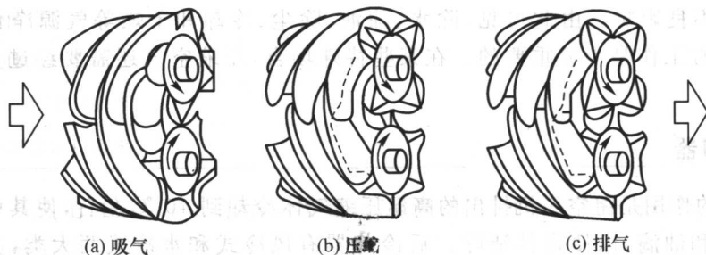
图 1-1-6 螺杆式空压机的工作原理图
