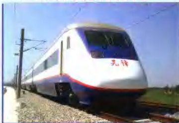
2. 动力分散型交直传动电动车组
