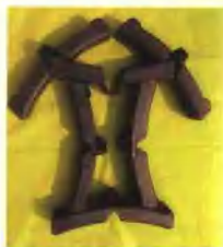
HGM-A、407QH、4-2W高低磨合成闸瓦
