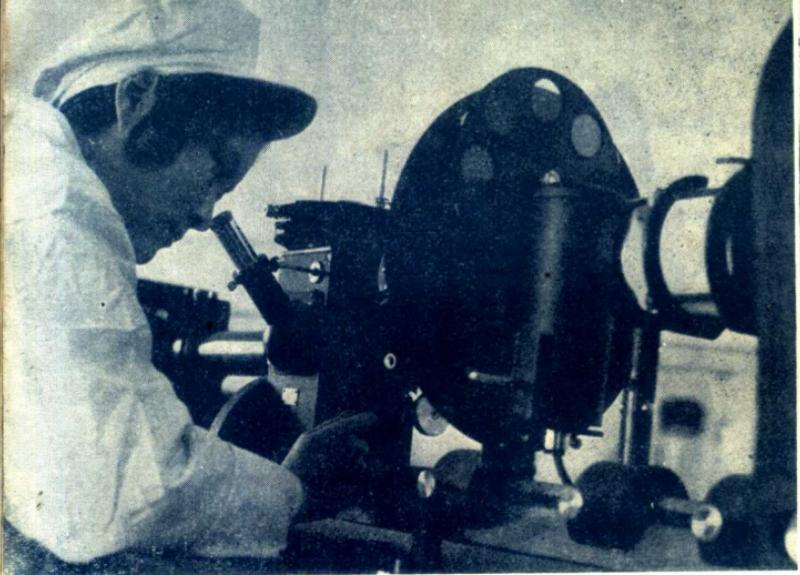
厂里設有完善的科学化驗设备和檢查仪器。图为在中央实验室的金相室内，檢查員在用金相显微鏡將制造好的板牙放大 600 倍，进行質量檢查。
