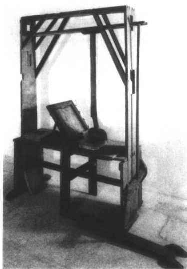
森纳菲尔德1797年使用的杠压式印刷装置
