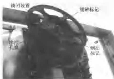
图 1-7 C 80(B) 型铝合金运煤敞车手制动装置
