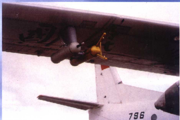
► 彩图4 机载PMS粒子测量系统探头
