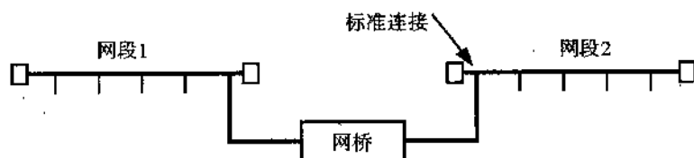
图 1-4 两个网络通过网桥实施连接的示意图
