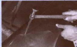
图 P11-6 轻轻敲击会有助于扁平已经隆起过高的表面。每敲击区域应平整度应合 \frac{1}{8} 英寸 (3.1 mm)，这样可以用车漆填孔。
