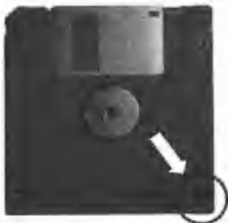
图 1-2 关闭软盘的写保护窗口
