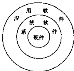
图 1-1 计算机系统的层次结构
