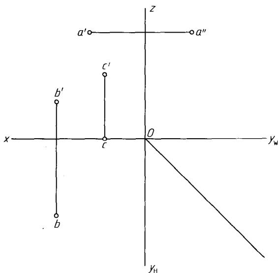
2-7 已知点 B 在点 A 的左边 20mm，在点 A 前方 10mm，比点 A 低 15mm，试作出点 B 的三面投影图
