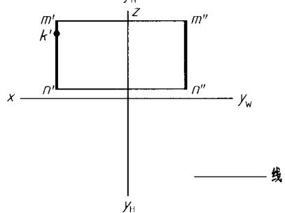
2-9 过已知点A作直线AB//H,且 $\beta=30^\circ$ ,实长为30mm,再过点A作直线AC,使AC垂直H,实长为20mm,作出两直线的投影
