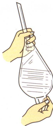
图 1-7 倒转分液漏斗时, 应使上下两个玻璃塞关闭
