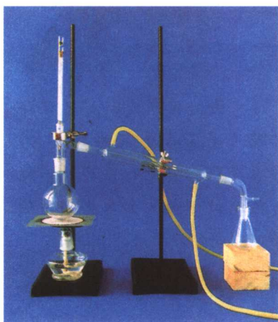
图 1-4 实验室制取蒸馏水的装置
