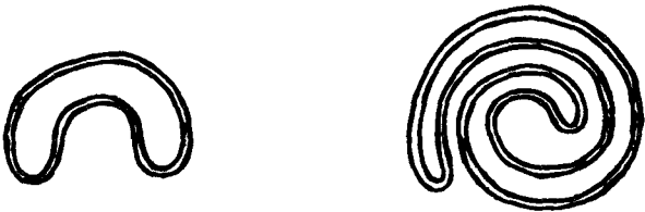
图 2 盘卷 O 形圈的参考方法
