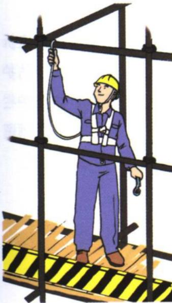
②在2米以上(含2米)有可能坠落的高处作业,必须系好安全带,安全带应高挂低用。
