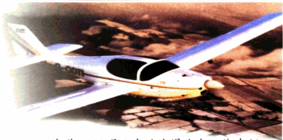
海燕 650B 是 3 座动力滑翔机，能在经过碾压的平坦地面上起降。它翼展 14.90 米，机长 7.02 米，实用升限 3850 米，续航时间 7 小时，最大航程 800 千米，其封闭式座舱既舒适又有安全感，适宜做初学者练习飞行的教练机。
