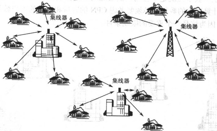
图 1-3 点到多点网络结构
