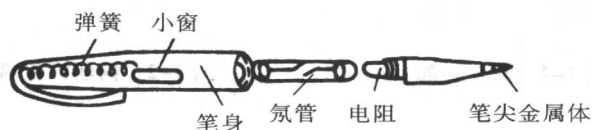
图 1-4 普通电笔的构造
