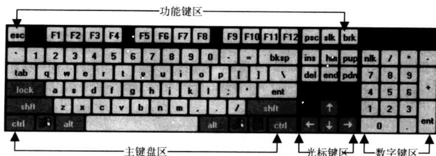
图 2-1 微机键盘结构
