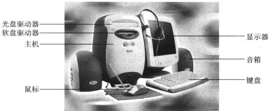
图 1-1 微型计算机硬件系统外观示意图
