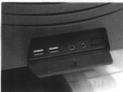
图 1-4 主机正面的 USB 接口和音频接口
