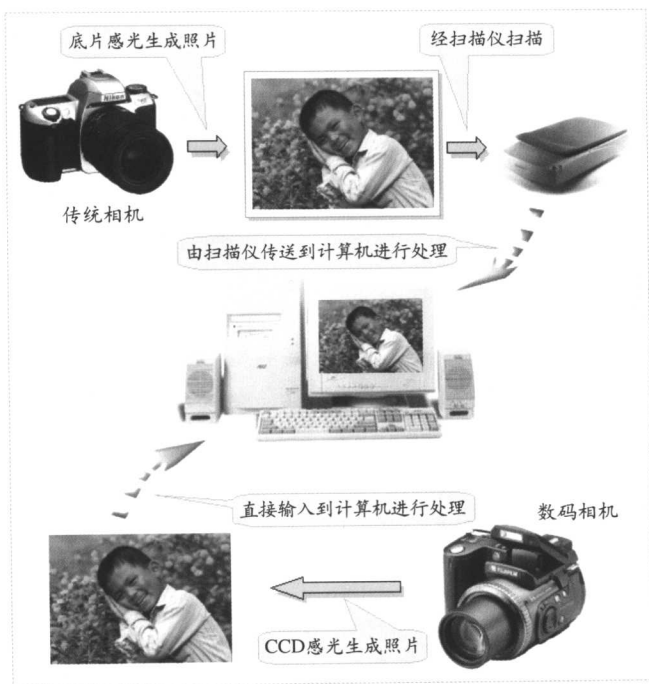
图 1-3 传统相机与数字相机生成数字照片的过程示意图
