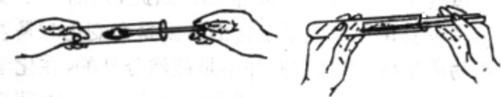
图 1-1-3 往试管里加入粉末状固体
