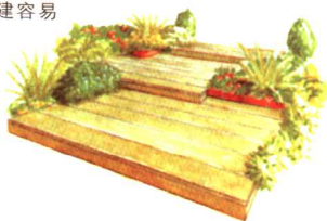
低跨度盖板台阶，适合有坡度的地面。
