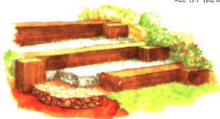
枕木立板、面宽，坡度小。踏板上铺鹅卵石。
