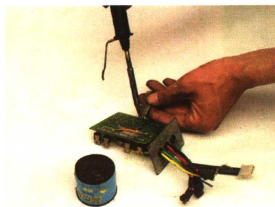
集成电路和功率器件的焊接
