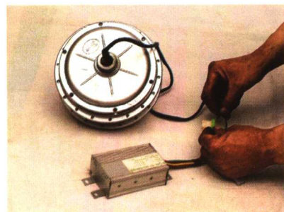
有刷电机与控制器的接线
