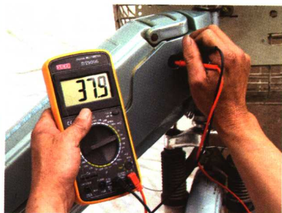
用万用表测量蓄电池电压值
