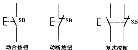
图 1-5 控制按钮的图形符号和文字符号
