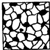
图 12. 再結晶退火后的組織( \times 300 )
