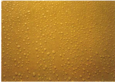
图 1-1 板材雨淋后集聚的水珠
