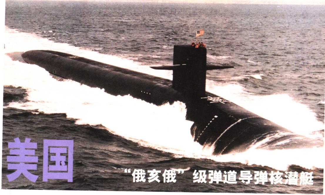
“俄亥俄”级弹道导弹核潜艇是美国最先进的第四代战略核潜艇，也是目前美国海军主要的水下核威慑力量。首艇于1981年11月正式服役，同级共建造了18艘。其水下排水量18700吨，下潜深度300米，水下航速20节，自给力70天。艇上可携载24枚射程为11000千米，带14个分弹头的“三叉戟Ⅱ”型潜射弹道导弹，还设有4具533毫米鱼雷发射管，可发射MK-48型鱼雷。
