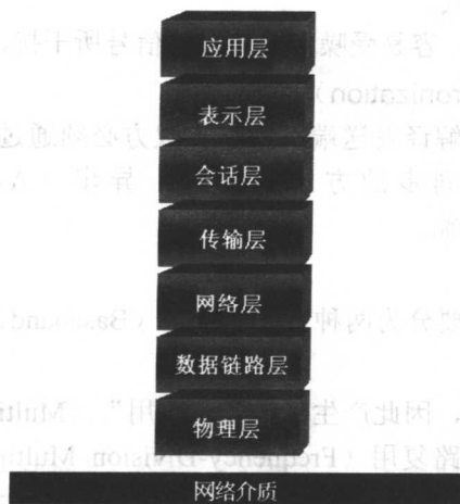
图 1-3 OSI 七层模型
