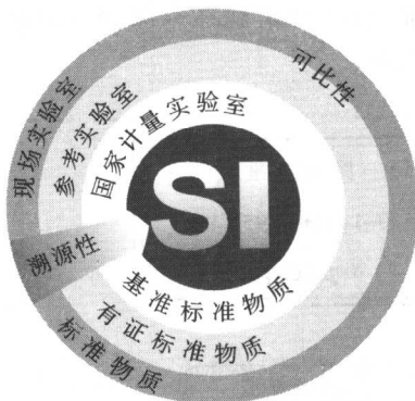
图 1.2 ISO/REMCO 绘制的化学测量溯源图
