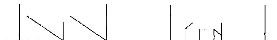
(3)一分格运行图,整分用短细竖线填记在时分线上,15 s用短竖线及线顶端加一向右上斜45°短横线填记在两时分线之间,30 s用短竖线及线顶端加一向右短横线填记在两时分线之间,45 s用短竖线及线顶端加一向右下斜45°短横线填记在两时分线之间。
