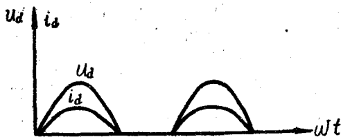
图 17-10. 半波整流电压和电流曲线。
