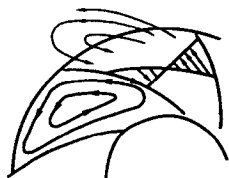
图 1-1-4 混流泵叶轮内的二次回流
