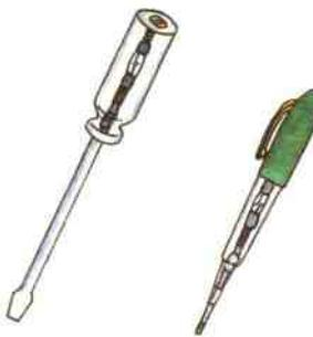
测电笔是电工和家庭必备的验电工具。它的外形有改锥式和钢笔式两种，但内部结构都是一样的，包括：金属探头、发光氖泡、降压电阻、弹簧、末端手触金属部分。
