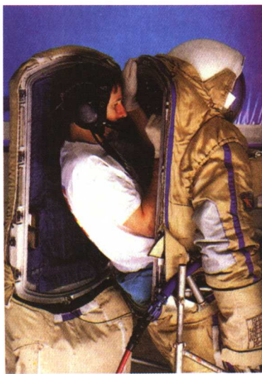
▲ 彩图 7 俄罗斯的太空服采用背脱式穿戴，穿起来比较贴身，有利于轨道作业，宇航员吸氧排氮的时间只需半小时
