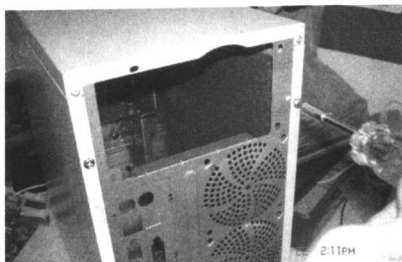
图 1.4 用螺丝刀拧下机箱板盖上的螺丝
