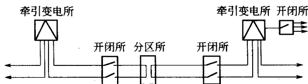
图 1—2 牵引变电所、分区所和开闭所
