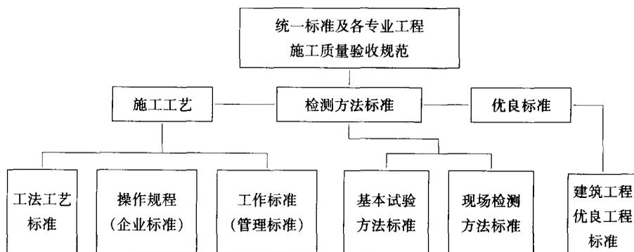
图 2-1 建筑工程施工质量验收规范支持体系
