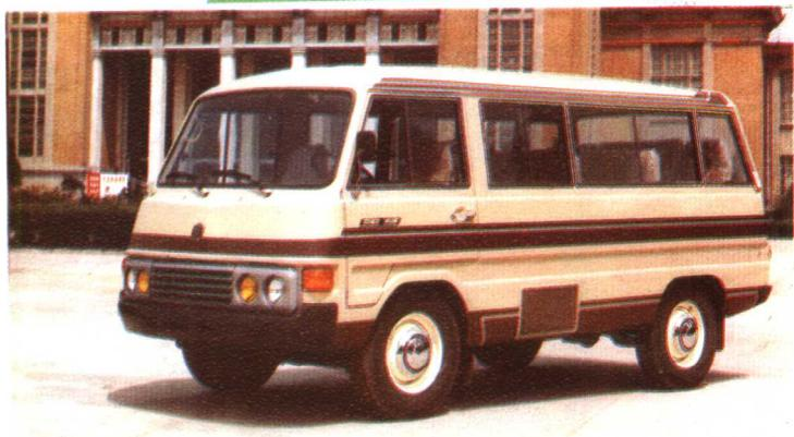
全长：4725毫米 总宽：1770毫米
